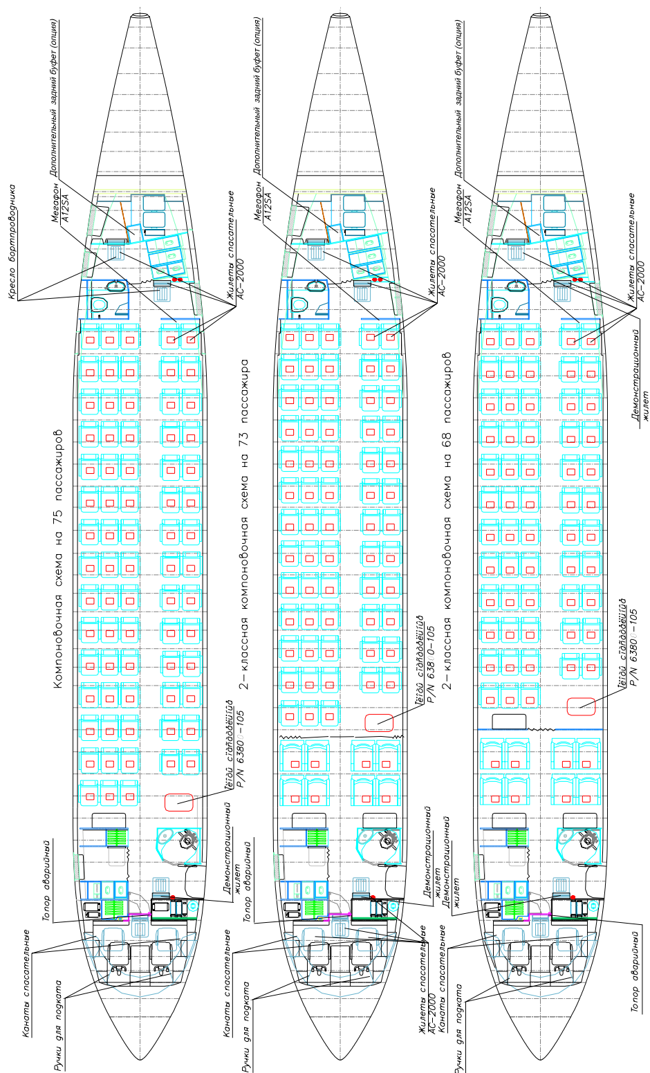
РАЗМЕЩЕНИЕ АВАРИЙНО-СПАСАТЕЛЬНОГО ОБОРУДОВАНИЯ (ЛИСТ 2 ИЗ 2)
